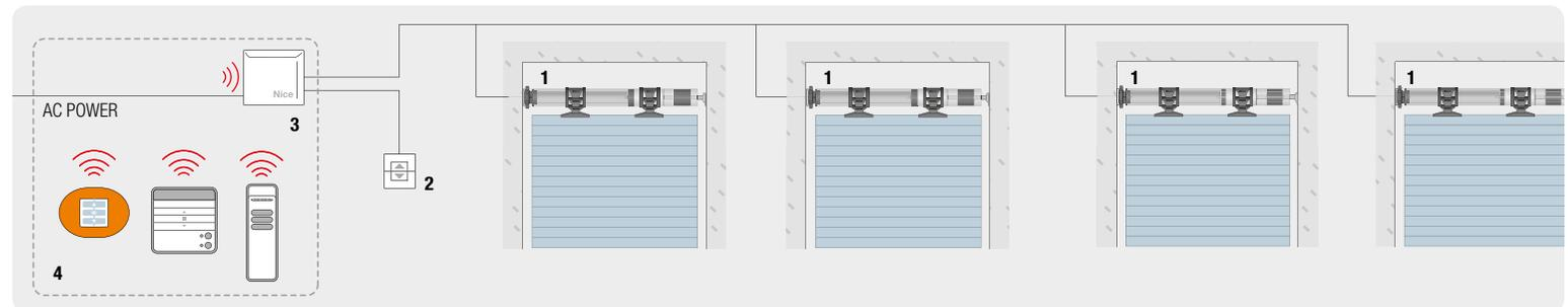
1. ROHRMOTOR 2. „AUF-/AB“-TASTE FÜR GRUPPENBEDIENUNG 3. STEUERGERÄT BAUREIHE MINDY TT4\* 4. SENDE R FÜR GRUPPENBEDIENUNG
