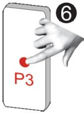
Drücken Sie 6 x die rückseitige P3-Taste des zu löschenden Senders.
