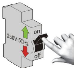
Nach korrektem Netzanschluss Netzversorgung einschalten.
