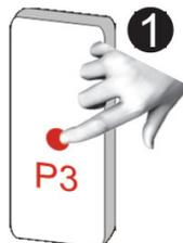
Drücken Sie 1 x die rückseitige P3-Taste des neuen Senders (innerhalb 8 Sekunden nach Netz Ein).
