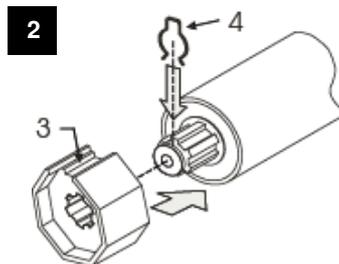
Wellen-Kupplung (3) auf Getriebebolzen schieben und durch Clip (4) sichern.
