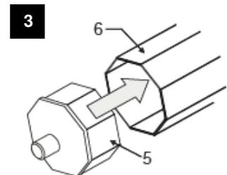
Führen Sie die Wellenkapsel (5) in die Rollladenwelle (6) ein.
