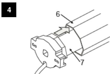
Den Einsteckantrieb (7) komplett in die Welle (6) bis zur Wulst des Stellings einschieben. NIEMALS EINSCHLAGEN!
