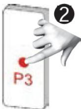
Drücken Sie 2 x die rückseitige P3-Taste eines bereits eingelernten Senders.
