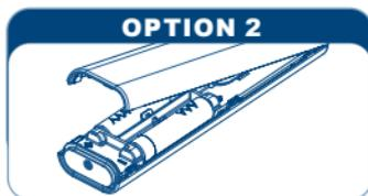
Eine Batterie kurz herausnehmen und wieder einsetzen
