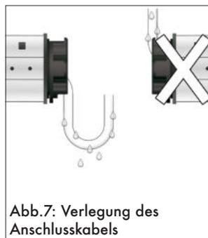
Abb.7: Verlegung des Anschlusskabels
