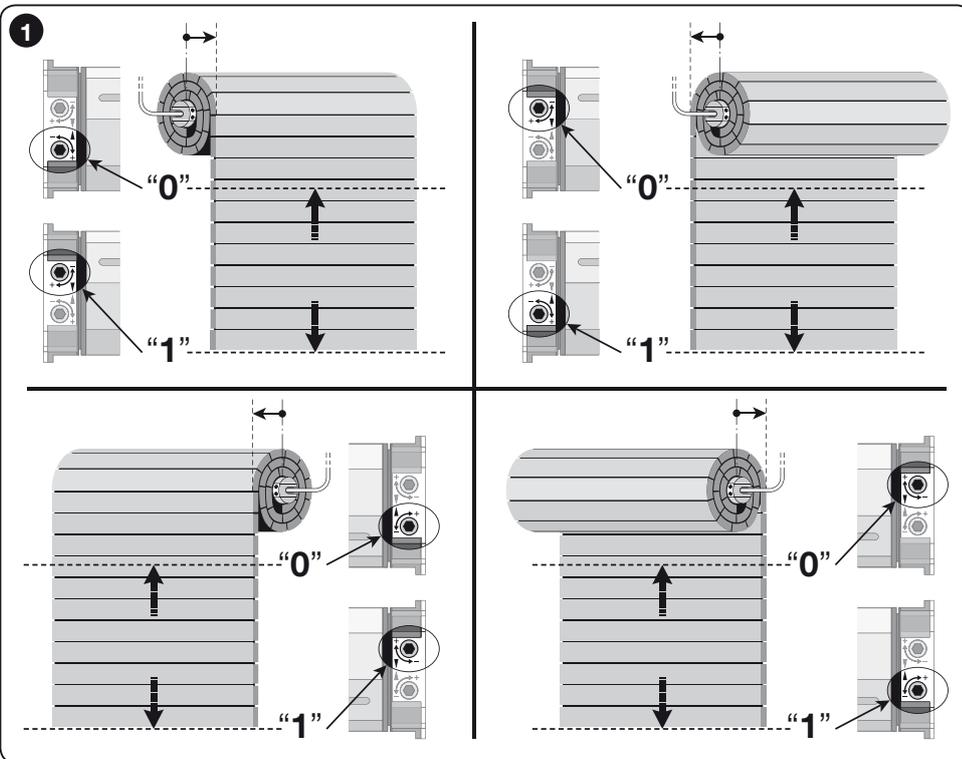
sie in die Startposition zurückkehrt; die Stellschraube des Endanschlags „0“ ein paar Umdrehungen in Richtung des Zeichens „-“ drehen, und schließlich das Verfahren von Punkt 04 wiederholen.
