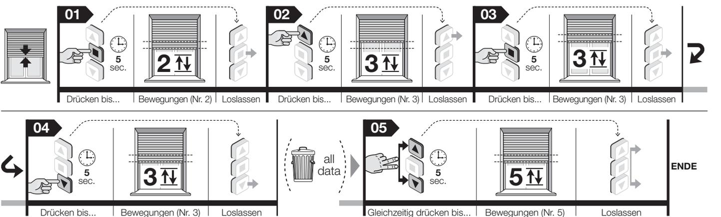
**Anmerkung** – Während der Ausführung der Verfahren, ist es jederzeit möglich die Programmierung durch gleichzeitiges Drücken der Tasten ■ und ▼ für 4 Sekunden zu annullieren. Als Alternative 60 Sekunden lang warten, ohne eine Taste zu drücken, bis der Motor 6 Bewegungen ausführt.
