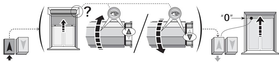
03. Infine, memorizzare la quota premendo a fondo (con l'aiuto di un cacciavite) il pulsante "a freccia" individuato prima, sulla testa del motore: questo **dove restare bloccato in posizione schiacciata**.
