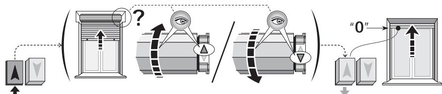
03. Na koniec wczytać wartość, wciskając do oporu (za pomocą śrubokrętu) zidentyfikowany wcześniej przycisk strzałki na głowicy silnika: przycisk ten powinien zostać zablokowany w położeniu wcisniętym.
