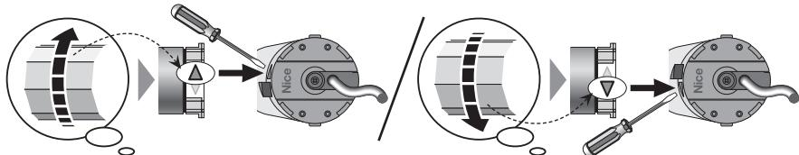
04. Per regolare l'altro finecorsa utilizzare la pulsantiera di comando a parete per portare la tapparella (o la tenda) alla quota desiderata per questo finecorsa.
