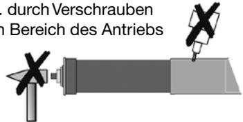
6. Die Welle mit dem Antrieb und der Wellenkapsel in den Lagern befestigen. Die Motorleitung nicht knicken und so verlegen, dass keine Schäden an der Leitung entstehen können. Um zu verhindern, dass Wasser in den Antrieb läuft, die Motorleitung in einem Bogen nach unten verlegen, damit Fließwasser abtropfen kann.
