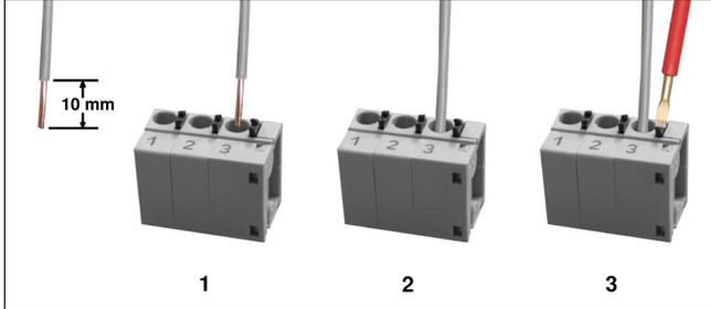
Abb. 2 Anschließen und Lösen der Leitungsverbindungen
