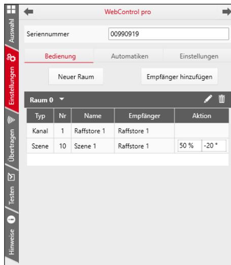
Hier wird die Oberflächenstruktur der Bedienseite parametrieren. Es sind maximal 50 Räume (logische Gruppen) möglich. Diesen Räumen werden dann die Empfänger zugeordnet. Empfänger können einzeln oder zu mehreren in Kanälen angelegt werden. Neben den Kanälen können auch Szenen angelegt werden, denen beliebige Empfänger zugeordnet werden können. Bei Aufruf einer Szene werden die hier parametrierten Aktionen ausgeführt.
