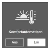
Hier können die Komfortautomatiken (Sonne, Dämmerung, Temperatur, Zeitschaltuhr) global für alle Empfänger im WMS Netz ein- oder ausgeschaltet werden.
